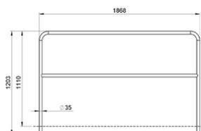
Garde corps en aluminium 2 barreaux - 2m
