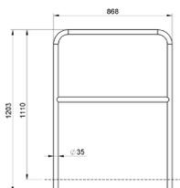
Garde corps en aluminium 2 barreaux - 1m
