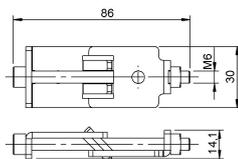
Pièce de connexion servant à relier des plateaux entre eux, SCA-05 et SCA-03 - Se fixe avec clef Allen 0.4
