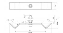
Fourreau de connexion servant a fixer garde-corps SBA-10 et SBA-12 sur escalier modulaire
