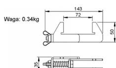
Pince de connexion pour assembler 2 podiums SCA-03. Serrage par vis papillon
